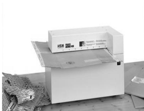
Cet équipement, de fabrication allemande, transforme en quelques secondes les cartons usagés des marchandises reçues en bandes « gaufrées » souples et flexibles.
